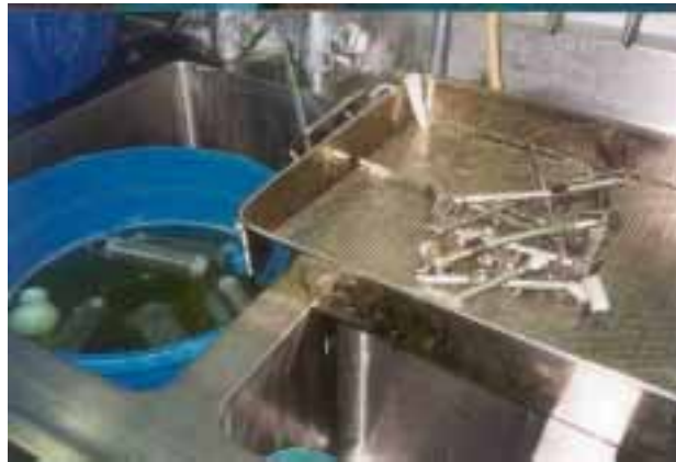
(Fig. No.1) Durante el lavado manual se recomienda contar con todos los insumos necesarios como: detergente enzimático, bandejas perforadas o fenestradas, lavatorios de plástico hondos, pozas de lavado hospitalario y cepillos que faciliten esta actividad.
